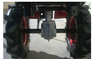
DETALLE RUEDAS 400 X 8 CON BUJE INCLUIDO
